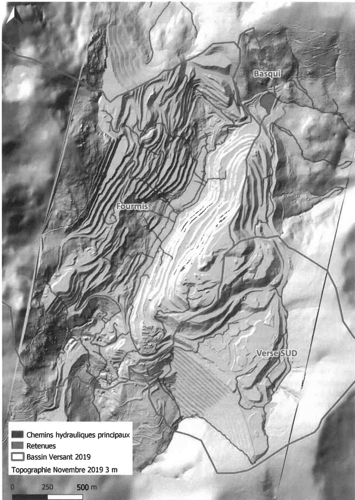
Figure 7 : Chemins hydrauliques principaux calculés à partir de la topographie d'Imerys Novembre 2019
